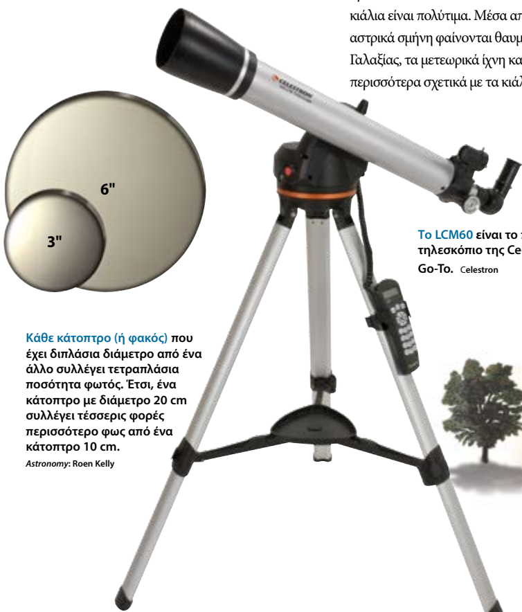
Τα τηλεσκόπια αναστρέφουν το είδωλο του στόχου, γεγονός που δεν ενοχλεί καθόλου, όταν κοιτάζετε ένα αντικείμενο στο διάστημα. Astronomy : Roen Kelly
