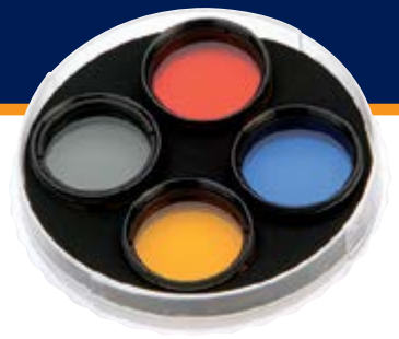
Το σετ προσοφθαλμίων φίλτρων της Celestron περιέχει ένα κόκκινο, ένα μπλε και ένα κίτρινο φίλτρο, που αναδεικνύουν λεπτομέρειες στους πλανήτες, καθώς και έναν φίλτρο ουδέτερης πυκνότητας, που μειώνει την ένταση του σεληνόφωτος. Celestron
