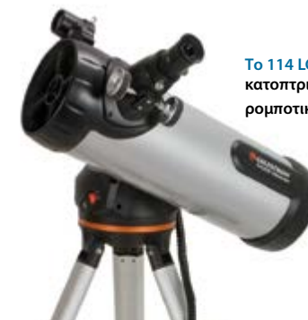
Ένα κατοπτρικό τηλεσκόπιο χρησιμοποιεί ένα κοίλο κάτοπτρο για να εστιάσει το φως και ένα μικρό επίπεδο κάτοπτρο για να το ανακλάσει προς το προσοφθάλμιο. Astronomy: Roen Kelly, after Celestron
